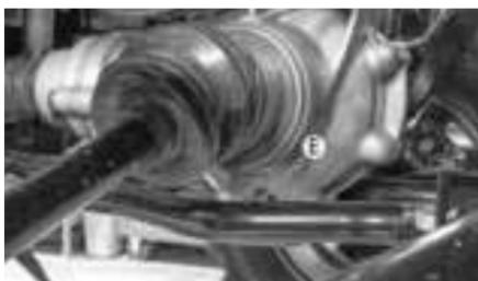
2. Vidangez l'huile dans un bac de récupération en retirant les bouchons de vidange: (E) différentiel avant côté droit et (D) boîte-pont.
